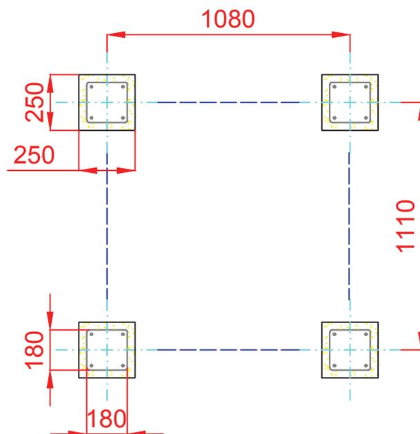
ESQUEMA DE CIMENTACIÓN EN HORMIGÓN
