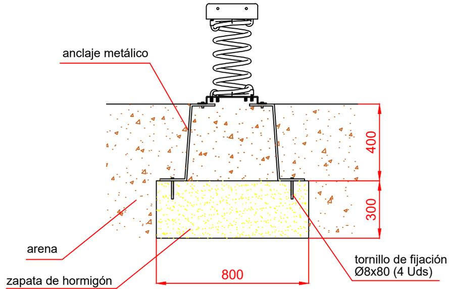
ESQUEMA DE CIMENTACIÓN EN HORMIGÓN
